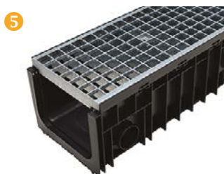
Afvoergoot type 200/150 Galva rooster B125 Weerstand : 12,5 t
