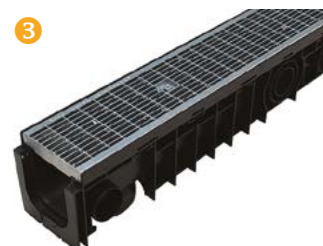
Caniveau type 100/100 Grille galva B125 Résistance : 12,5 t
