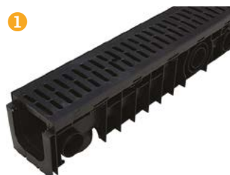
Caniveau type 100/100 Grille Polypropylène A15 Résistance : 1,5 t
